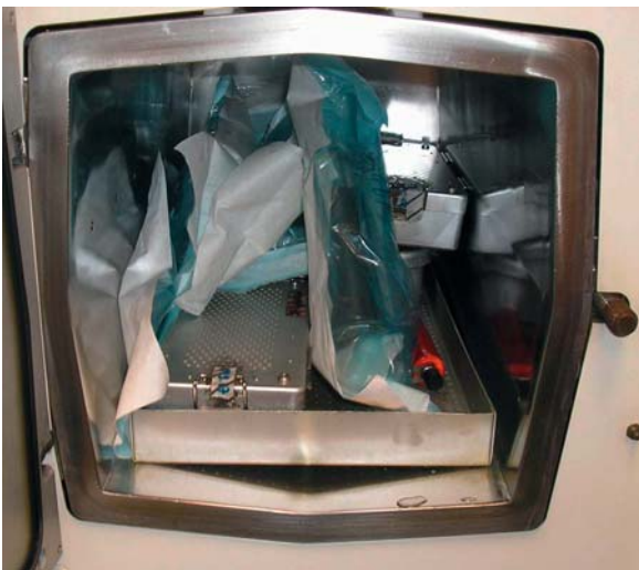
Falsch: Keine gesicherte Sterilisation durch „Unordnung“
