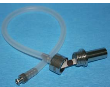
Typ. Indikator in Prüfkörper für die Reinigungskontrolle bei MIC-Instrumenten, z. B. von www.simicon.de , www.bag-germany.com , www.van-dijk-medical.de
