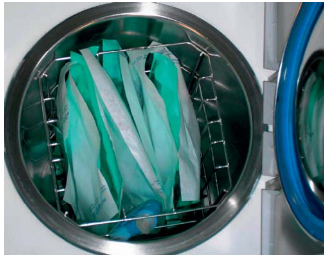
Richtig: Typ. Beladung nach Herstellerangaben (z. B. Papier auf Folie) inklusive Chargenprüfkörper (PCD-Helix)
