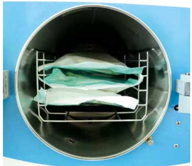
Richtige Beladung nach Herstellerangaben: Papier auf Papier, Folie auf Folie
